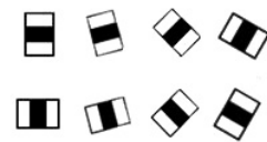
Рисунок 3. Разновидности вейвлетов Хаара для детектирования тонких линий с различными углами наклона
