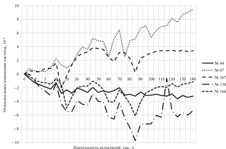
Рисунок 1. Относительное изменение частоты резонаторов РК429С при длительных испытаниях на безотказность
