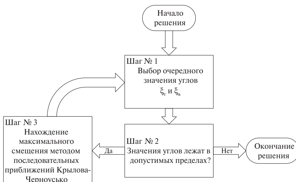
Рисунок 3. Блок-схема алгоритма построения области начальных положений
